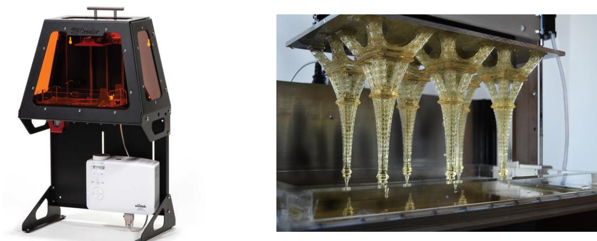
Figura 2: Exemplo de impressora 3D (B9, 2015) e produto pelo método SLA (TANGIBLE, 2015)
